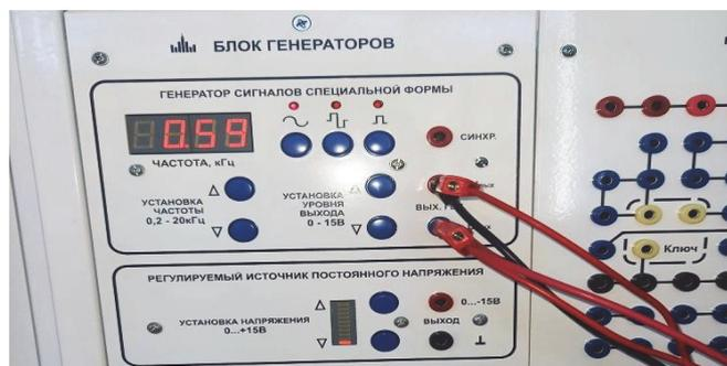
Рисунок 1 – Блок генерации напряжения
