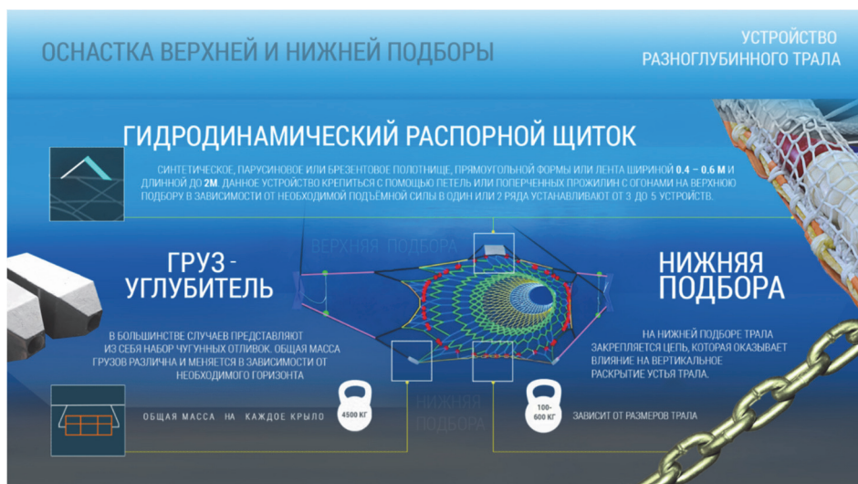
Рисунок 1 – Устройства раскрытия устья разноглубинного трала
