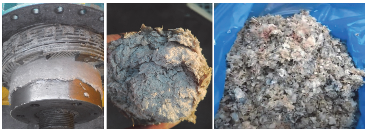
Рисунок 6 – Костный остаток с испытаний сепаратора из контр-винтовых шайб: а, б – вид мясокостного остатка, получаемого при помощи обвалочного прессы УШПМ-1; в – вид мясокостного остатка из прессы AM2C/SD2050
