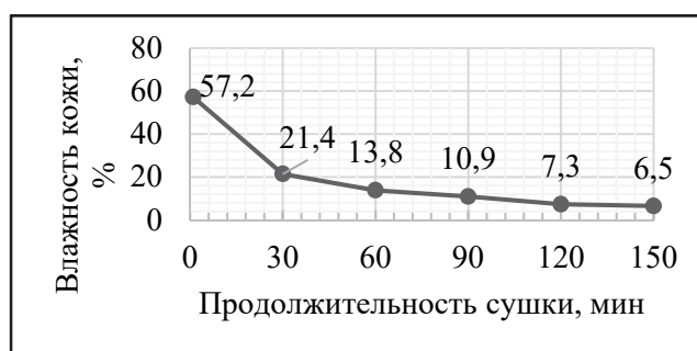
Рисунок 2 – Зависимость влажности от времени сушки при температуре 90 °С
