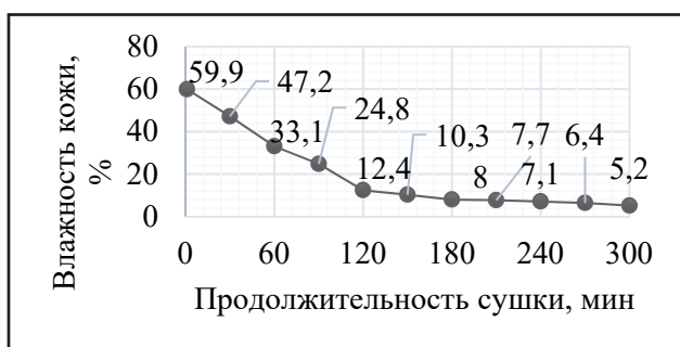
Рисунок 1 – Зависимость влажности от времени сушки при температуре 45 °С
