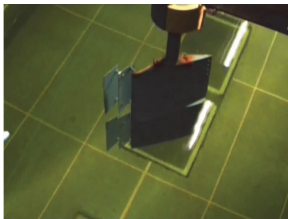
Рисунок 5 – Эксперименты с моделью траловой доски
