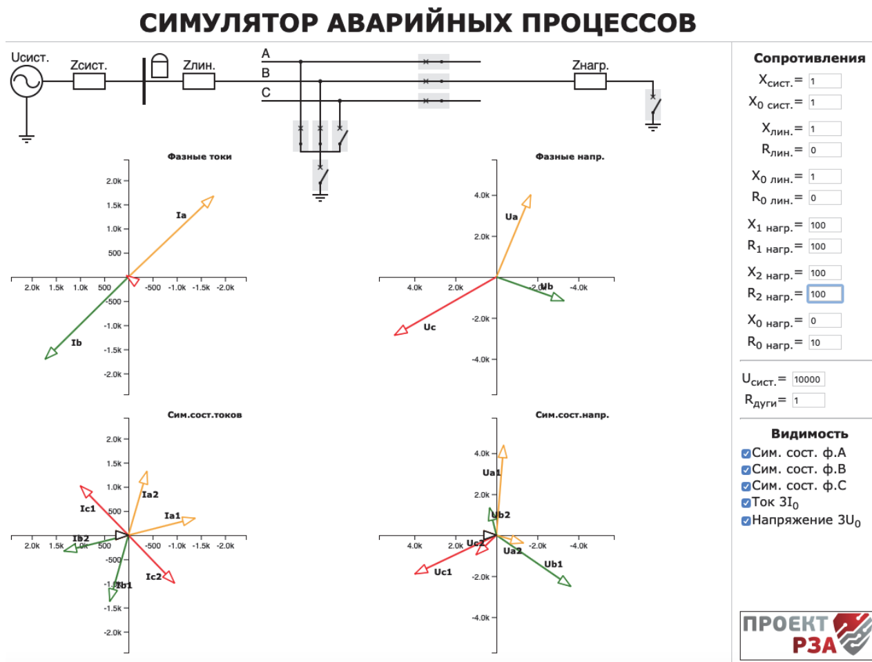
Рисунок 2 – Определение токов аварийных режимов. Расчёт минимального значения тока двухфазного КЗ I_{КЗ,МИН}^{(2)} . Параметры системы следующие: сопротивления на нагрузках повышены до значений в 100 Ом. Замыкаем фазы А и В
