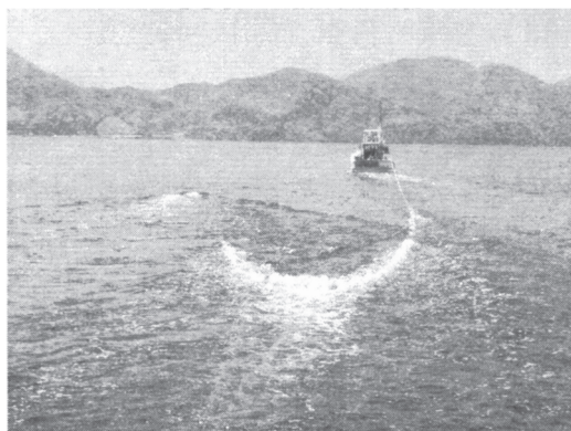
Рисунок 6 – Фотографии боковой буксировки трала [4, с. 47–53]
