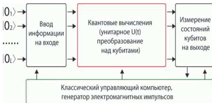
Рисунок 2 – Схема идеального квантового компьютера
