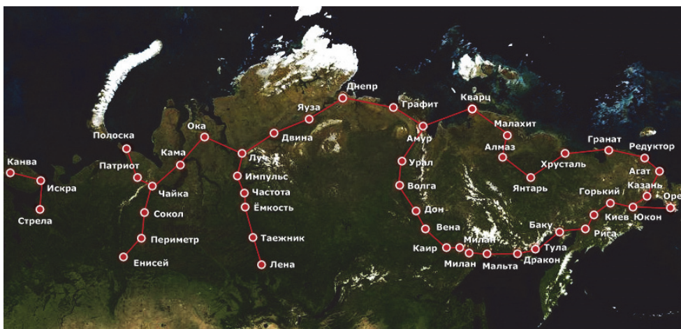
Рисунок 3 – Схема узлов связи тропосферной радиорелейной линии связи «Север»
