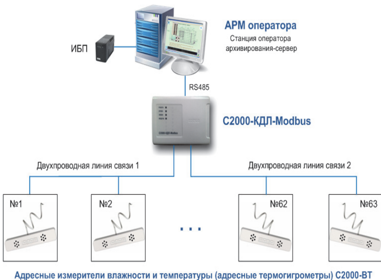
Рисунок 3 – Структурная схема автоматизированной системы мониторинга температуры и влажности
