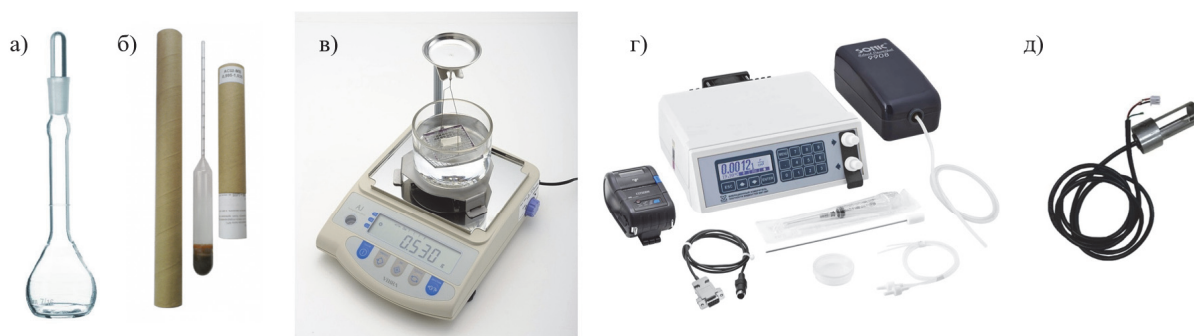
а) пикнометр пж-2-100 КШ 10/19, б) ареометр для морской воды АМВ 1000-1040, в) весы для гидростатического взвешивания AJ-620CE, г) вибрационный плотномер вип-2мр, д) ультразвуковой датчик плотности DM500
