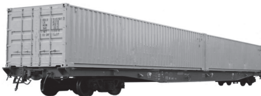
Рисунок 2 – Фитинговая платформа модели 13-6851-01
