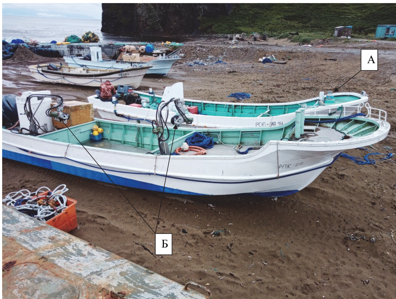
Рисунок 6 – Японские боты (кавасаки): А – турачка; Б – переборочная машина
