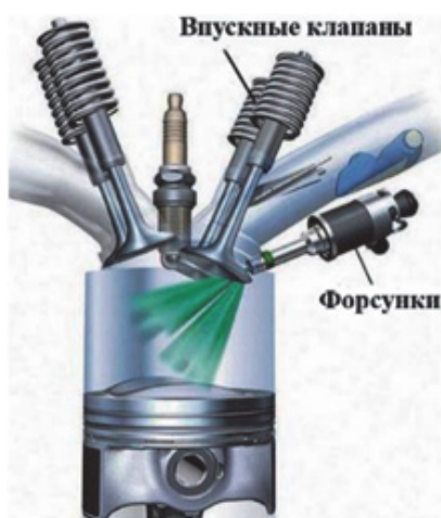
Рисунок 3 – Устройство непосредственного впрыска топлива [2]
