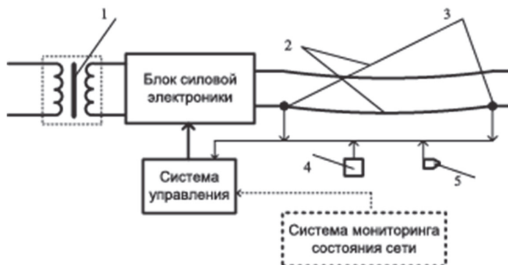
Рисунок 7 – Система электромеханического воздействия на провода воздушной линии для удаления гололёда.
