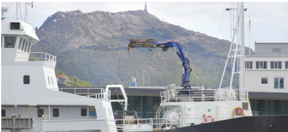
Рисунок 1 – Кран с поворотной стрелой с семью степенями свободы, установленный на борту корабля
