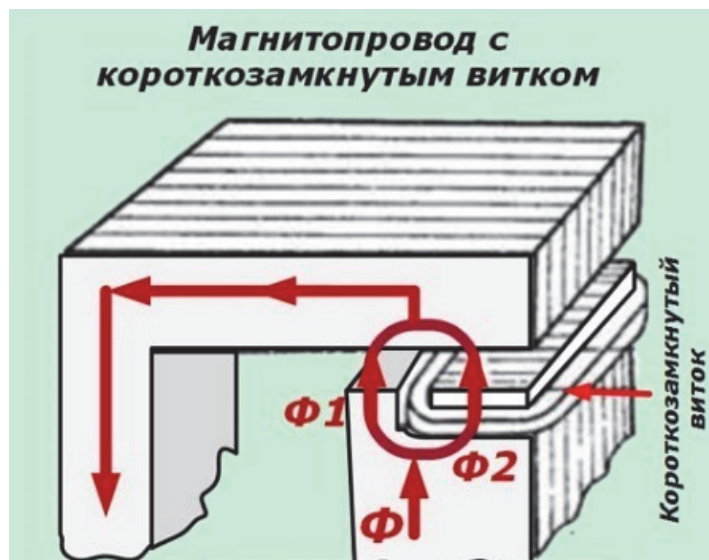
Рисунок 5 – Магнитопровод с короткозамкнутым витком
