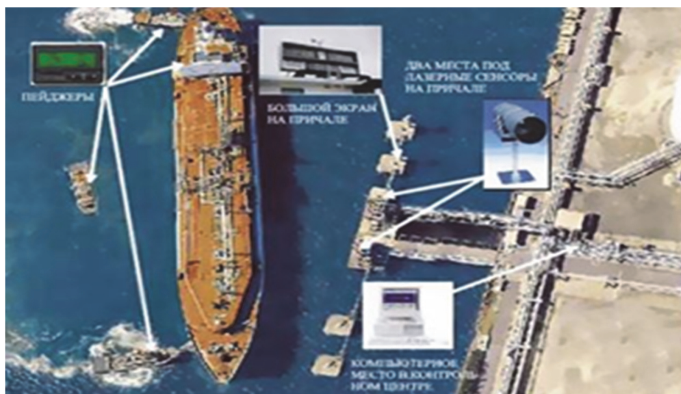
Рисунок 5 – Лазерная система швартовки крупнотоннажных судов
