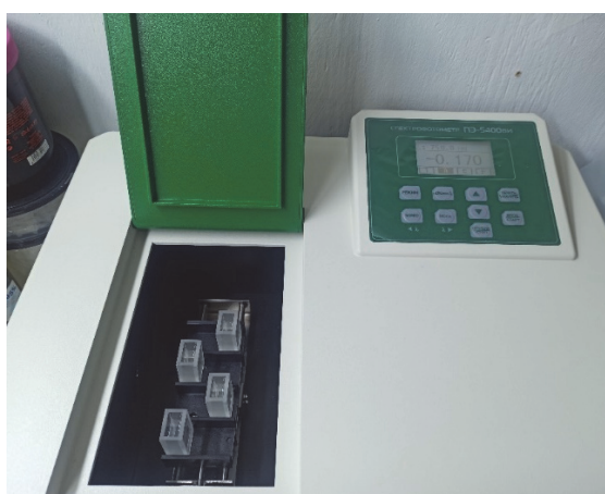
Рисунок 2 – Измерение на оптической плотности на спектрофотометре Экрос
