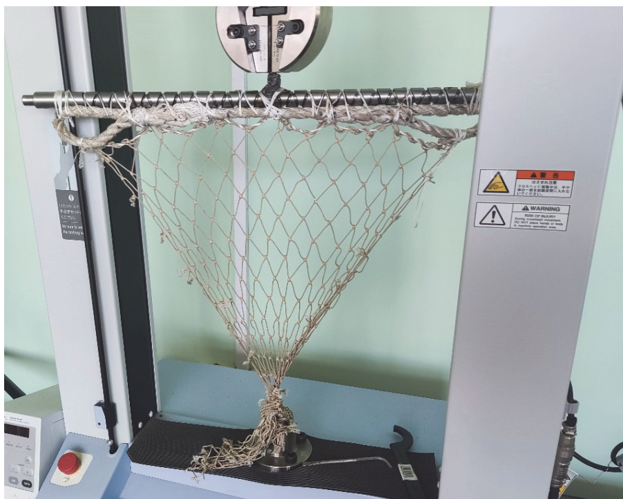
Рисунок 3 – Конструкция элемента верхней подборы без опушки, закрепленная в разрывной машине
