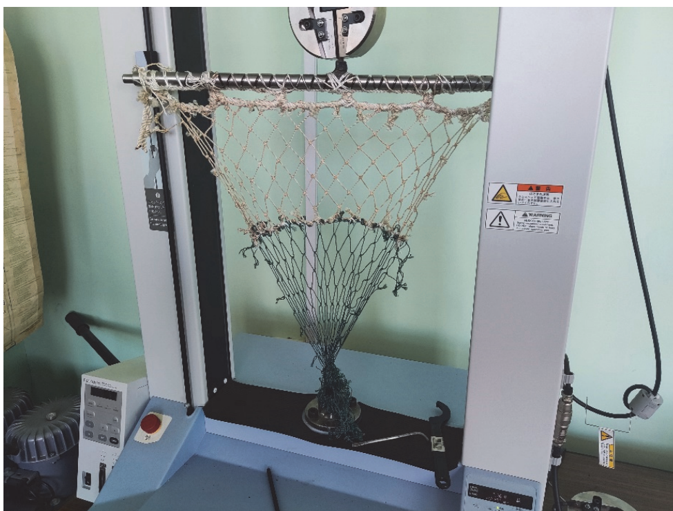
Рисунок 1 – Конструкция элемента верхней подборы с опушкой, закрепленная в разрывной машине
