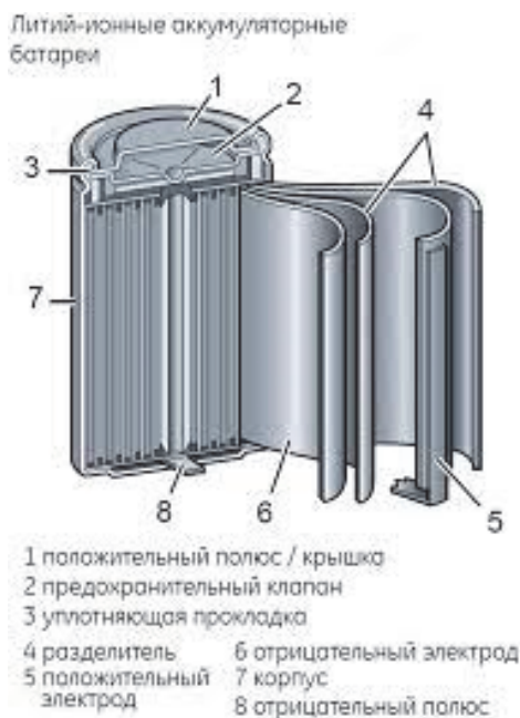
Рисунок 2 – Строение литий-ионного аккумулятора
