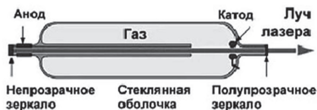
Рисунок 3 – Строение газового лазера
