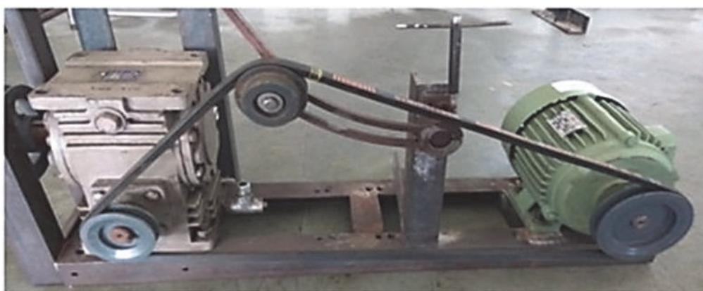
Рисунок 3 – Испытательный стенд определения потери мощности в червячной передаче при перемешивании
