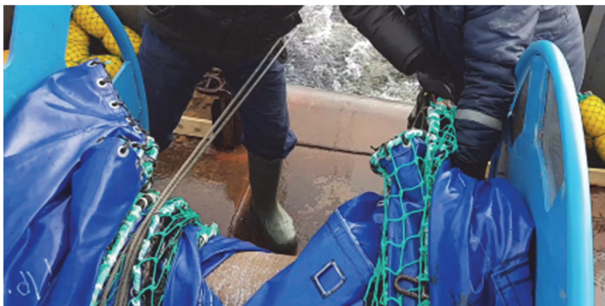
Рис.7. Наматывание ГРУ на кабельно-сетной барабан
