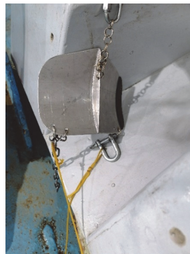
Рис. 13. Установленные и подключенные траловые доски
