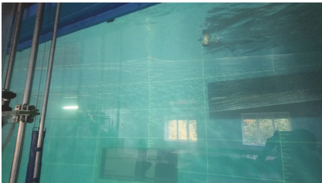
Рис. 18. Раскрытие трала в водном потоке на заданной длине ваеров
