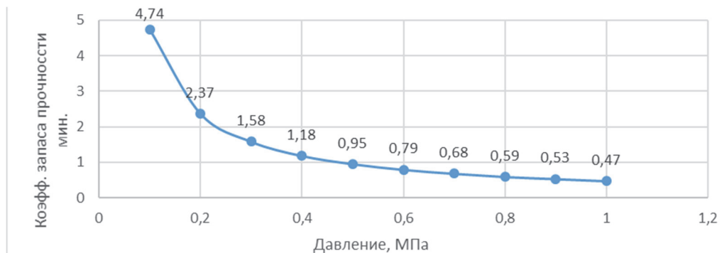
Рисунок 4 – Зависимость коэффициента запаса прочности от показателей давления на скребке
