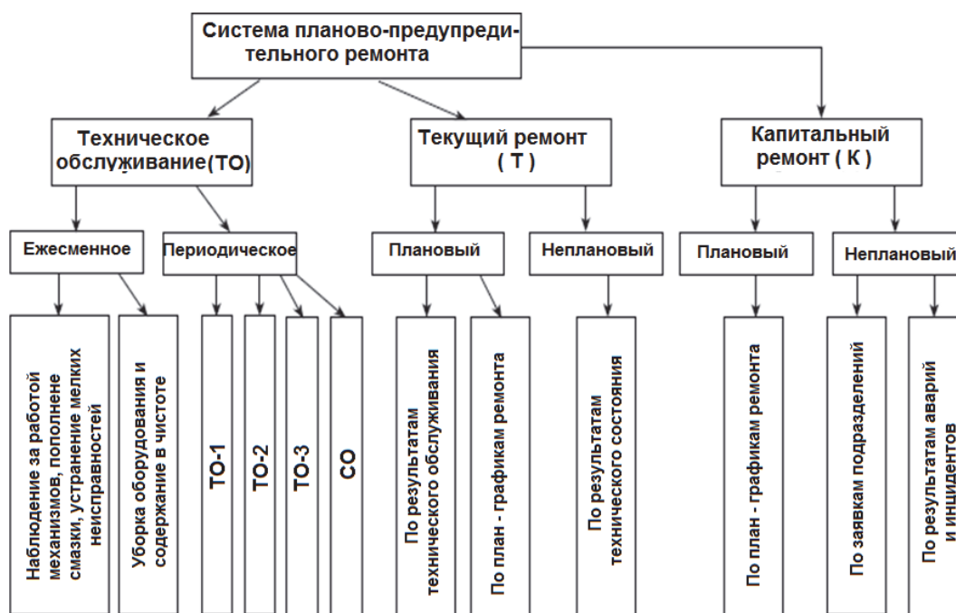
Рисунок 1 – Дифференциация работ по системе планово-предупредительного ремонта
