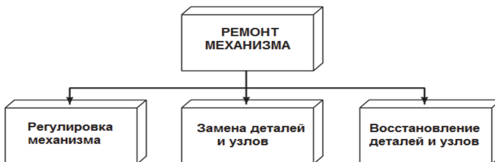
Рисунок 3 – Ремонтные операции для оборудования
