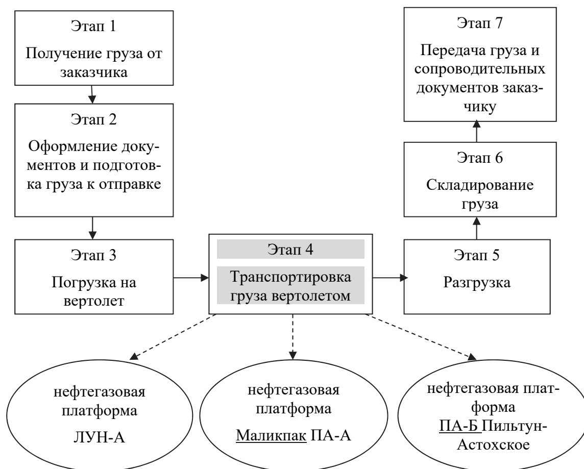
Рисунок 3 – Схема организации доставки грузов вертолетом от Морского терминала Набиль на нефтегазовые платформы
