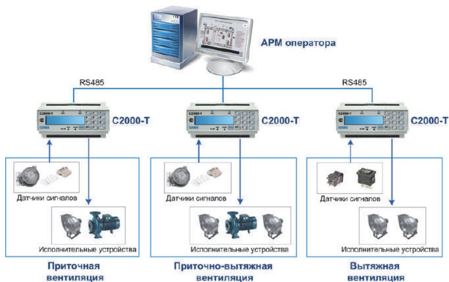
Структура АСУ на базе SCADA КРУГ-2000
