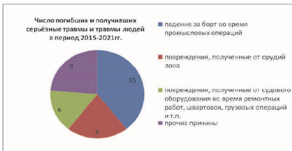
Рисунок 5 – Распределение аварий, связанных с тяжелыми травмами или гибелью людей на рыбопромысловых судах в весенне-летний период по видам происшествя
