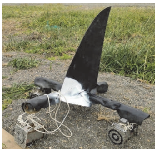
Рисунок 4 – Гидробионический макет косатки, оснащённый электродинамическими извещателями биосигналов косаток (фото автора)
