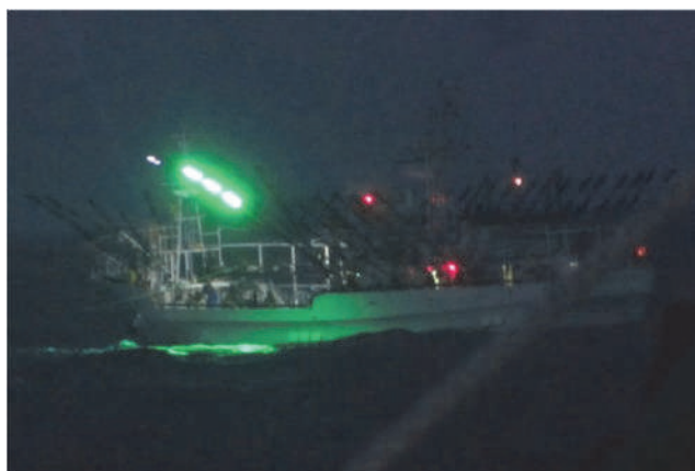
Рисунок 9 – Концентрация сайры у поверхности с помощью лампы зеленого света
