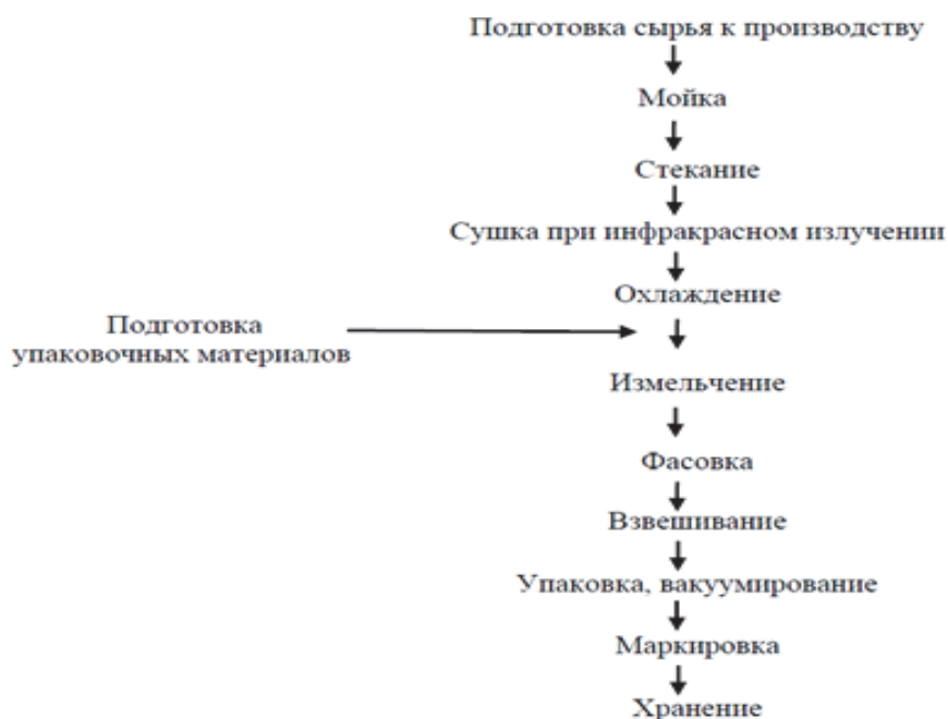
Рисунок 2 – Технологическая схема производства пищевого обогатителя из покровных тканей кальмара
