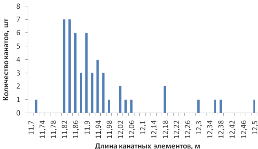
Рисунок 14 – Разброс длины канатных элементов крыльев трала с фабричным размером 12,0 м
