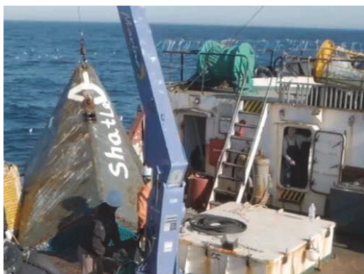
Рисунок 5 – Устройство для накопления улова на судне РК «Восток-1»
