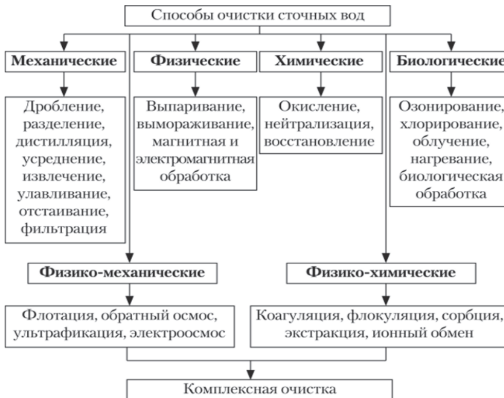
Рисунок 1 – Методы очистки сточных вод
