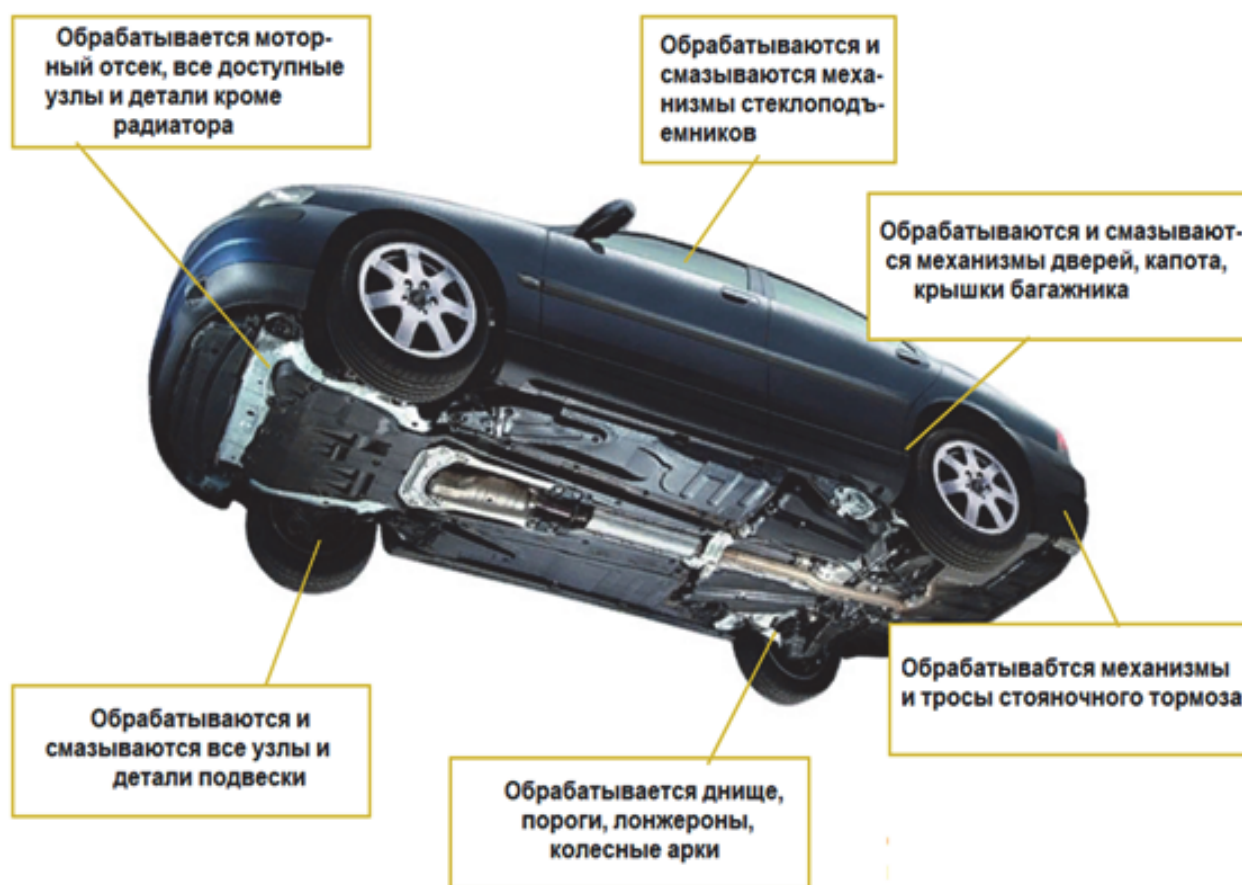
Рисунок 2 – Технология антикоррозионной обработки Krown T-40
