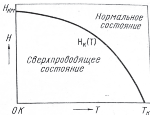
Рисунок 2 – Зависимость критического поля сверхпроводника от температуры
