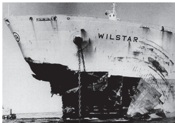
Рисунок 5 – Пример разрушения судна от удара волны
