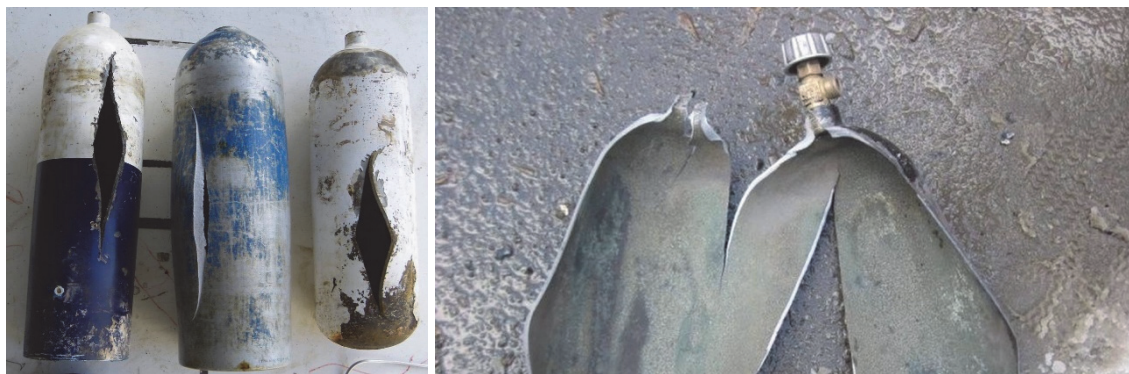
Рисунок 5 – Внешний вид взорвавшихся баллонов
