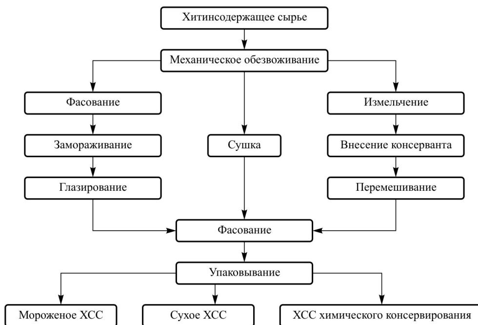
Обобщенная технологическая схема заготовки хитинсодержащего сырья
