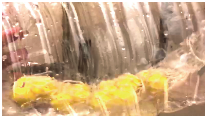
Рисунок 2 – Положение физической модели мешка при всхожести судна на волну
