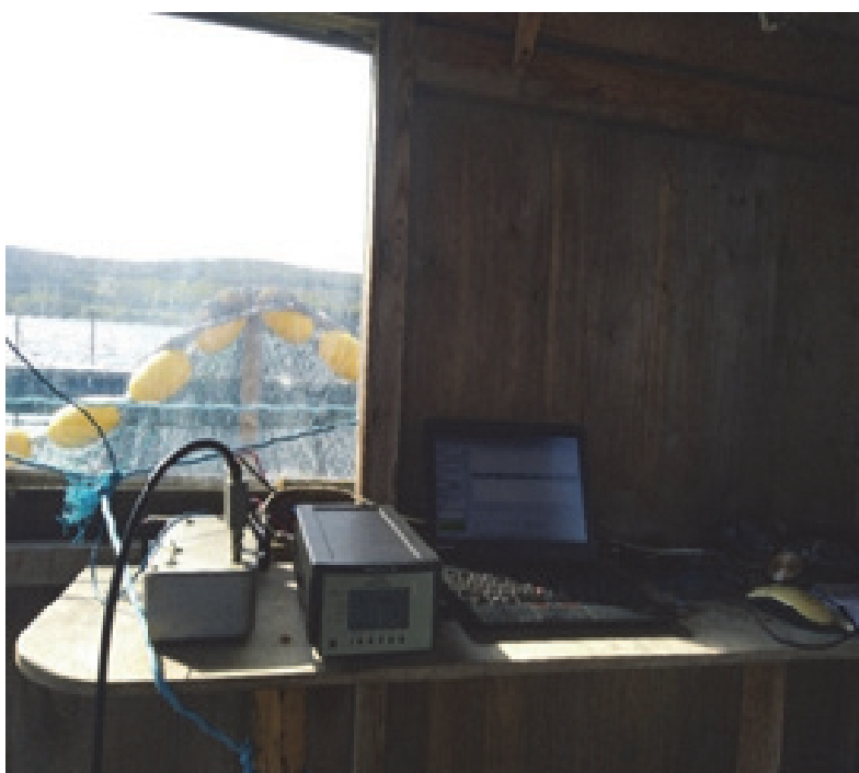
Рисунок 2 – Аппаратура, используемая для регистрации акустических сигналов и шумов, размещенная в павильоне. Слева направо: согласующее устройство и устройство оцифровки сигналов, 4-канальный усилитель 2693-OS4 компании «Брюли и Къер», персональный компьютер
