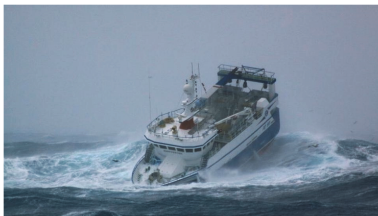
Рисунок 2 – Слеминг с оголением кормовой оконечности траулера «Тамозh»
