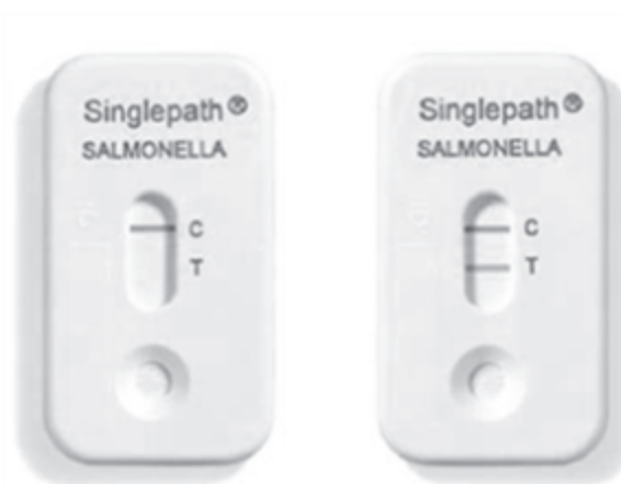
Рисунок 4 – Иммунографический тест Singlepath® для экспрессного выявления сальмонелл (слева – отрицательный ответ, справа – положительный ответ)
