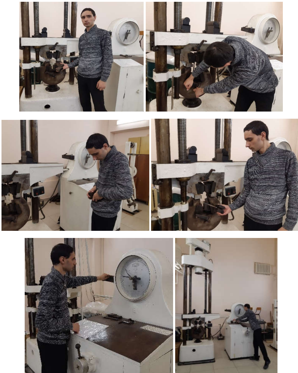
Рис. 3. Экспериментальные исследования образца при нагружении – растяжение
