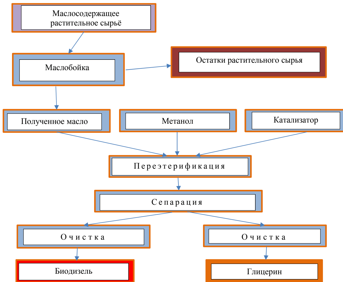
Рис. 1. Схема производства биодизеля из растительного сырья
