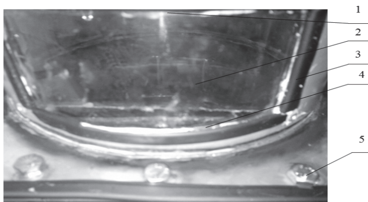
Рис. 3. Смотровое окно с подсветкой: 1 – подсветка из светодиодов; 2 – окно из оргстекла (внутреннее и наружное); 3 – резиновое уплотнение; 4 – герметик; 5 – нержавеющие болты
