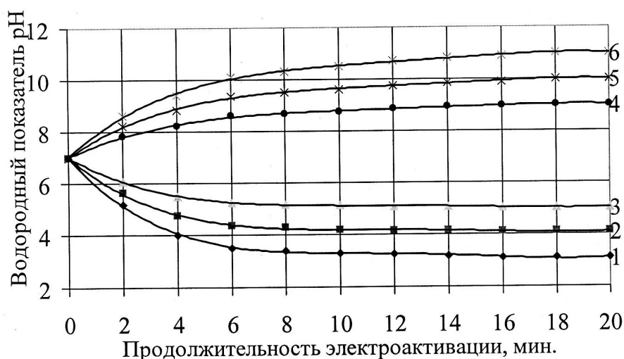
Рис. 2. Зависимость водородного показателя pH электроактивированной воды от продолжительности электроактивации и подаваемого напряжения (1, 6 – 220 В, 2, 5 – 165 В, 3, 4 – 110 В)
