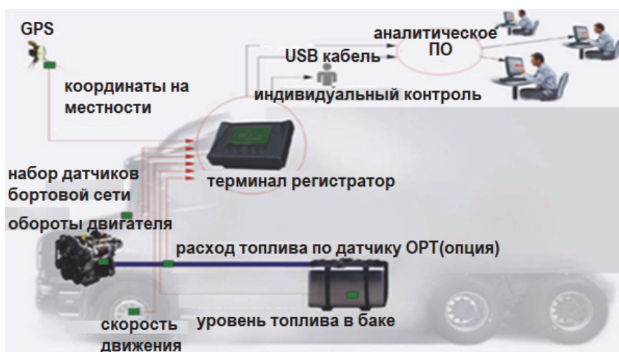
Рис. 4. GPS-системы контроля расхода топлива
