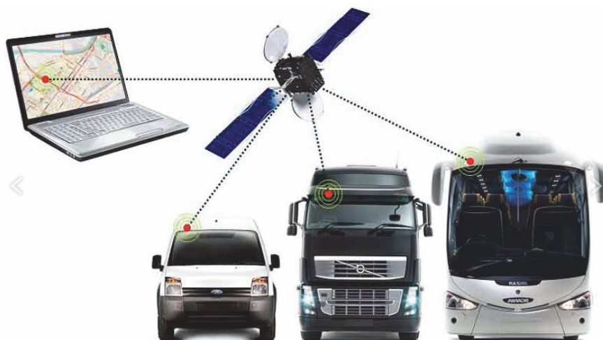
Рис. 2. Слежение за несколькими транспортными средствами с помощью системы ГЛОНАСС
