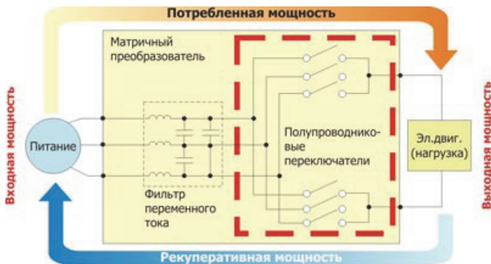
Рис. 2. Все составляющие электропривода с НПЧ
