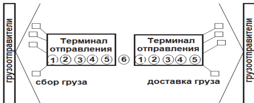
Рис. 4. Схема терминальной перевозки: 1 – таможенная очистка груза; 2 – разгрузка; 3 – сортировка (полгруппировка); 4 – хранение груза; 5 – погрузка; 6 – линейная перевозка
