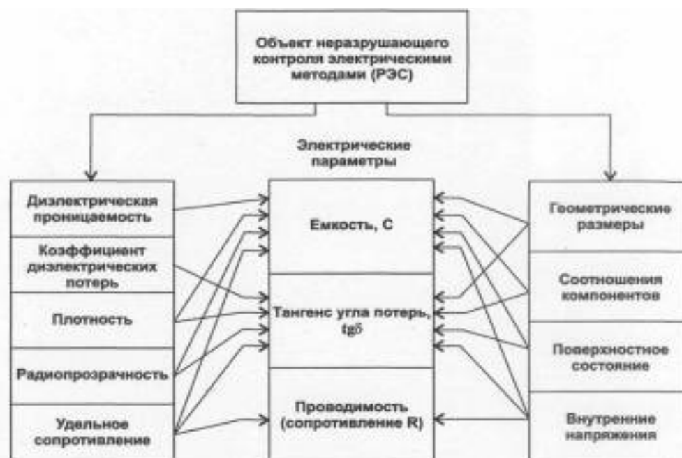
Рис. 1. Схема воздействия характеристик объекта контроля на электрические параметры
