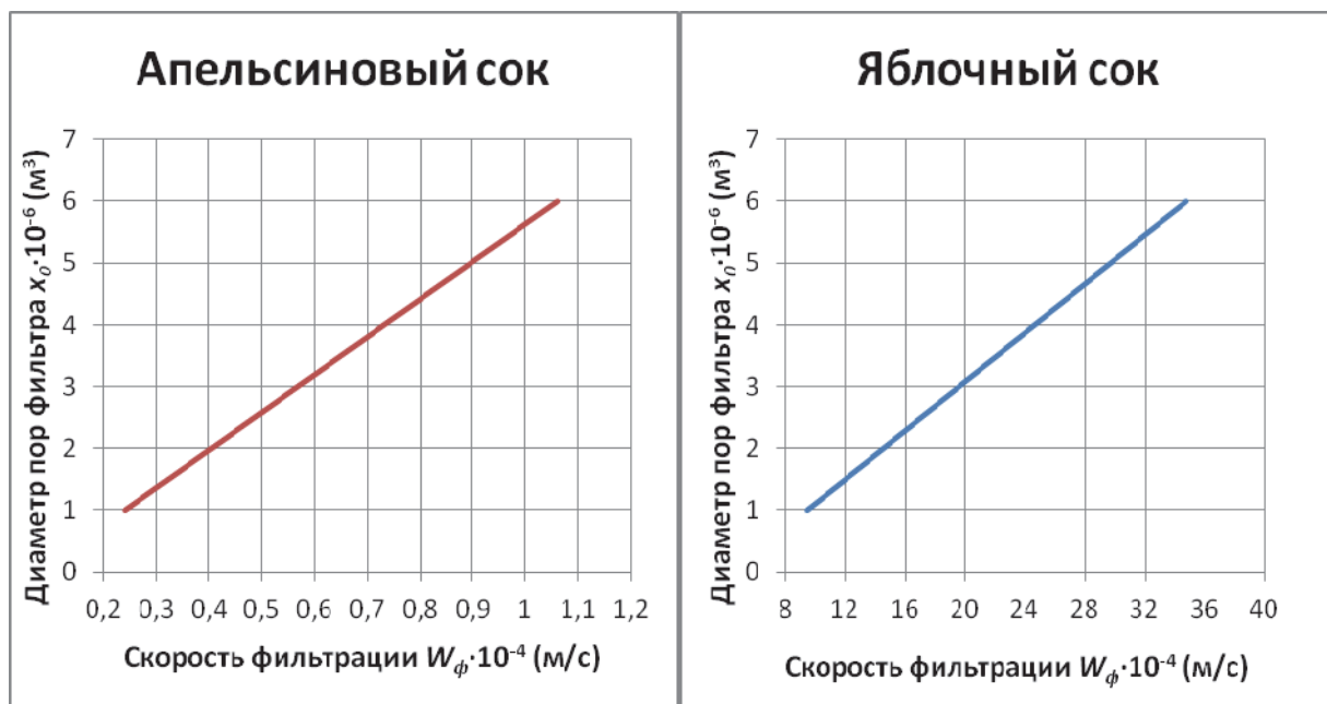
Рисунок 4 – Зависимость скорости фильтрации от диаметра пор фильтрующей перегородки
